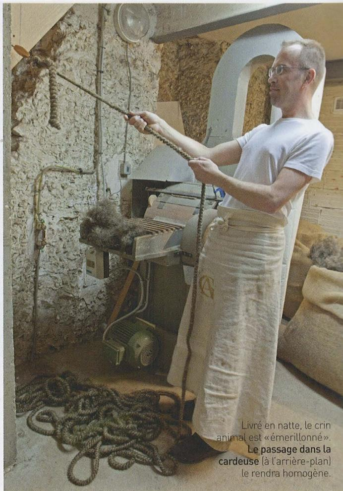
Livré en natte, le crin animal est «émerillonné». Le passage dans la cardeuse (à l'arrière-plan) le rendra homogène.
